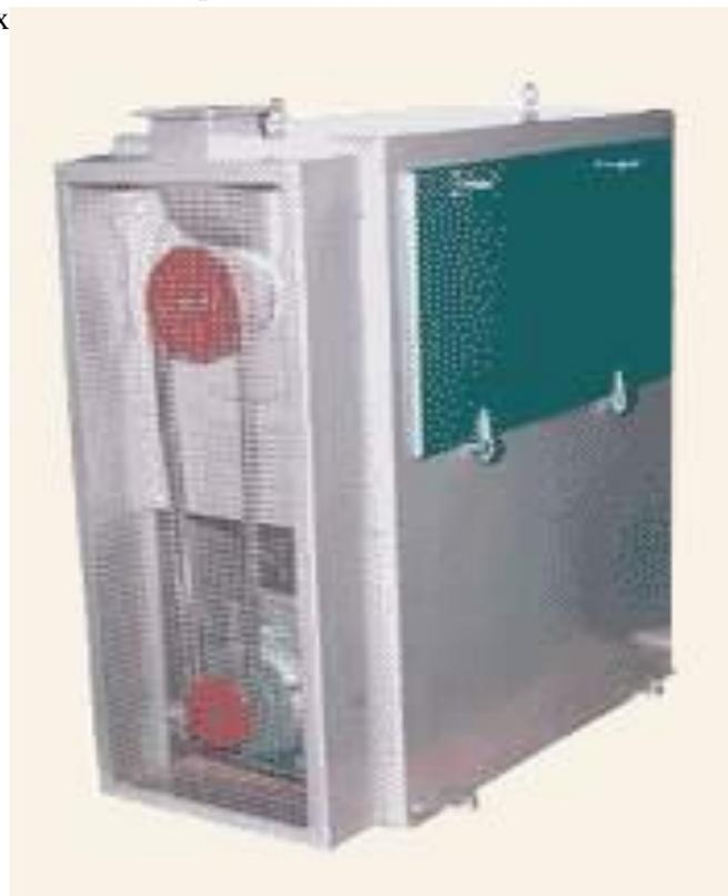
Также предлагаются компактные обоечные машины производительностью 2 т/ч.
