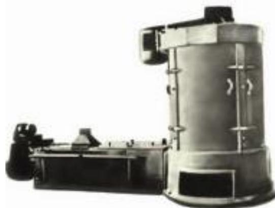
Машина моечная состоит из двух основных частей: ванны моечной и колонки отжимной. В ванне моечной происходит влажная очистка зерна и осуществляется передача зерна в колонку отжимную. В колонке отжимной влажное зерно, прижатое к сетчатой обечайке, лопатками барабана подается вверх, осушается, частично шелушится и очищается от органических примесей.
