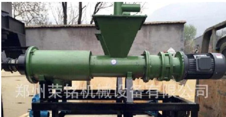
Шнековый бур сепаратора имеет лопасти, состоящие из **Итальянской нержавеющей стали Aisi 304** высокого качества. Высокий уровень обезвоживания, и конечно простота в эксплуатации. Просто нажать одну кнопку для запуска или остановки работы, низкое энергопотребление подходит для непрерывной работы. Обезвоженная масса на выходе практически не имеет запаха. В последующем может использоваться в качестве основы для удобрений.
