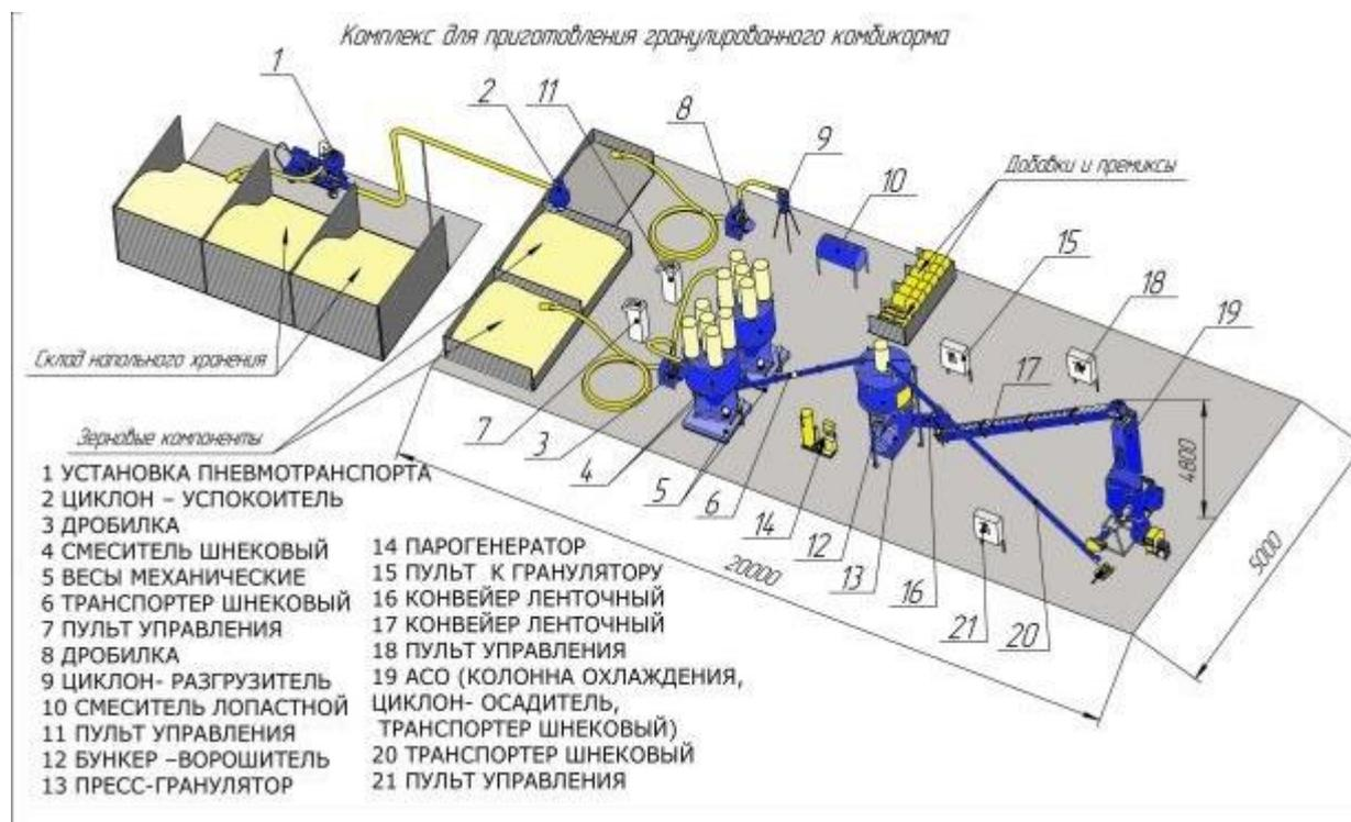
Комплекс комбикормовый предназначен для производства гранулированных комбикормов с БВМД:
