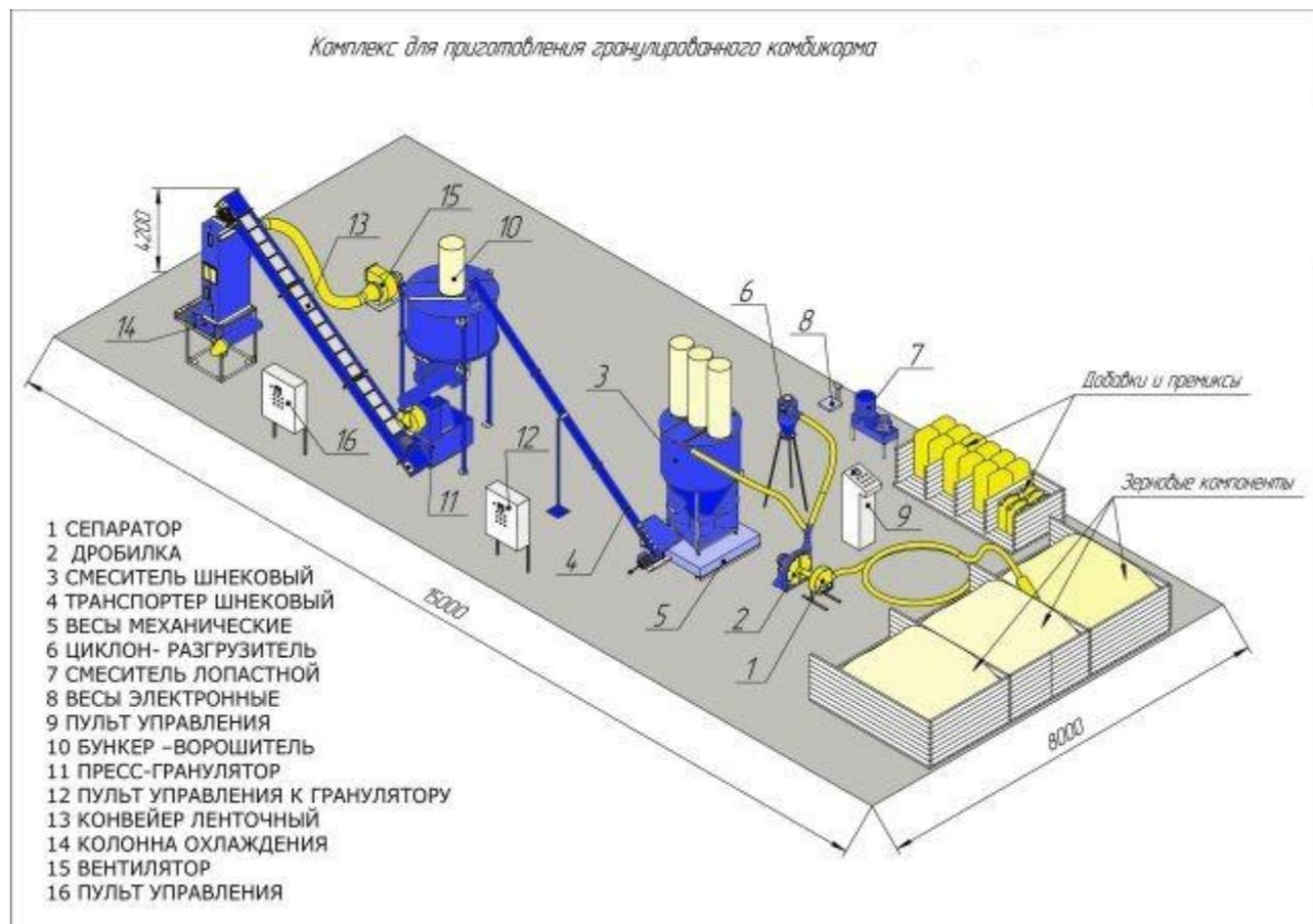
Комплекс комбикормовый предназначен для производства гранулированных комбикормов с БВМД:
